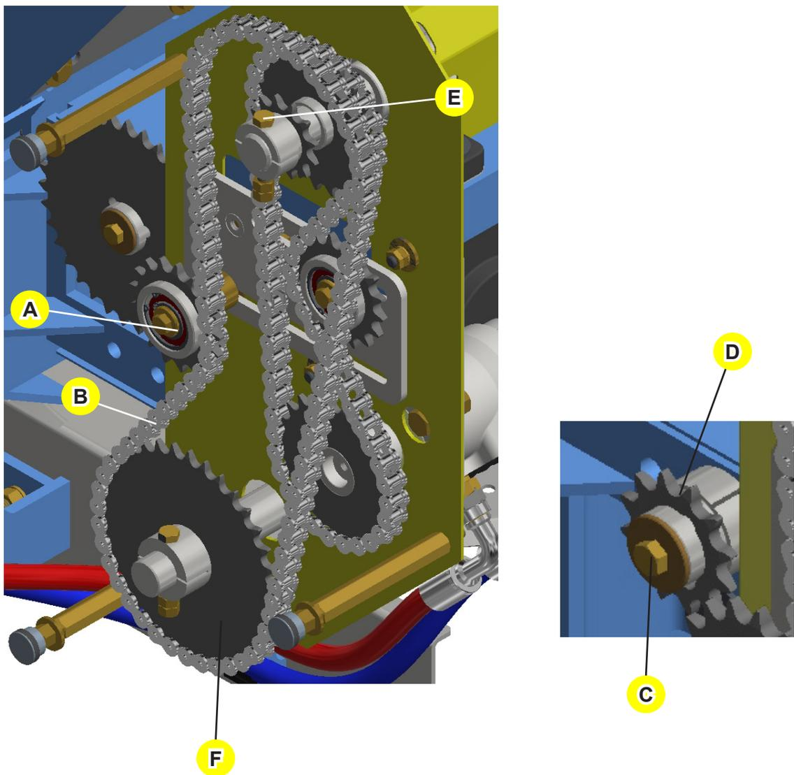
**OBS.** Quando for utilizar a roda dentada de 12 dentes (D) é necessário retirar 10 elos da corrente, que já vai com 2 emendas para facilitar a troca.
