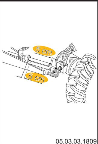
VERIFIQUE O COMPRIMENTO DO EIXO CARDAN ANTES DE INICIAR O USO DO EQUIPAMENTO E TODA VEZ QUE TROCAR O TRATOR.
