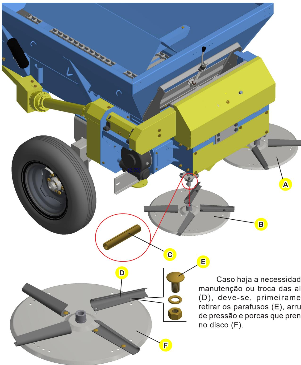
Caso haja a necessidade de manutenção ou troca das aletas (D), deve-se, primeiramente, retirar os parafusos (E), arruelas de pressão e porcas que prendem no disco (F).
