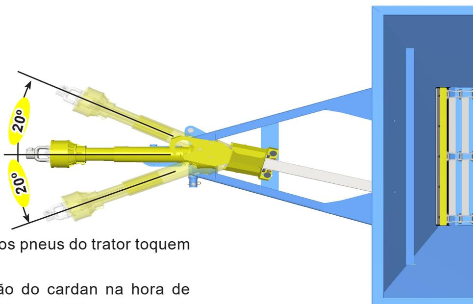
Evite manobras que os pneus do trator toquem no cabeçalho.
