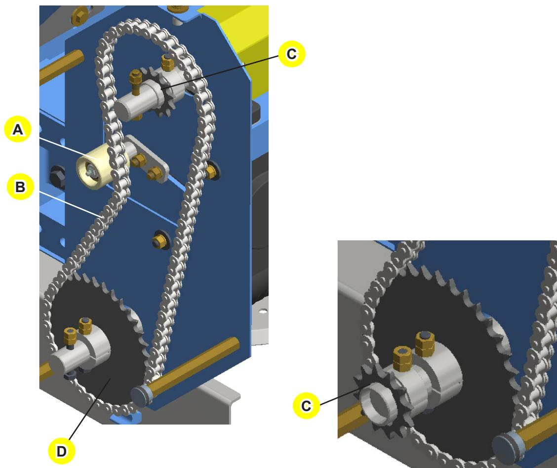
**OBS.** Quando for utilizar a roda dentada de 12 dentes (C) é necessário retirar 10 elos da corrente, que já vai com 2 emendas para facilitar a troca.
